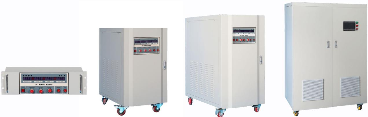
单相变频电源采用 DSP 数字芯片控制 SPWM 脉冲调制技术，整个电路是由交流一直流一交流一滤波构成的变频装置，输出为纯净的正弦波，输出频率和电压一定范围内可调。它有别于用于电机调速用的变频调速控制器，也有别于普通交流稳压电源，能模拟输出不同国家的电网指标，可以输出任何国家的电网电压和频率。变频电源是非常接近于理想的交流电源。
