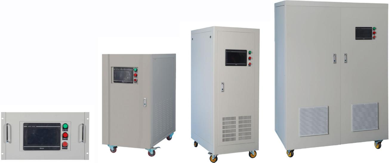
SPS 系列三相变频电源采用 DSP 数字芯片控制 SPWM 脉冲调制技术，整个电路是由交流一直流一交流一滤波构成的变频装置，输出为纯净的正弦波，输出频率和电压一定范围内可调。它有别于用于电机调速用的变频调速控制器，也有别于普通交流稳压电源，能模拟输出不同国家的电网指标，可以输出任何国家的电网电压和频率。变频电源是非常接近于理想的交流电源。
